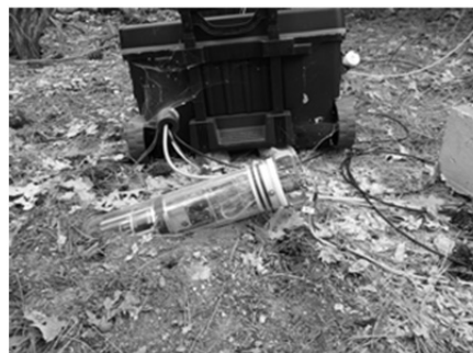
アメリカ、カリフォルニアの半乾燥地に設置した自動ミニライゾトロン
