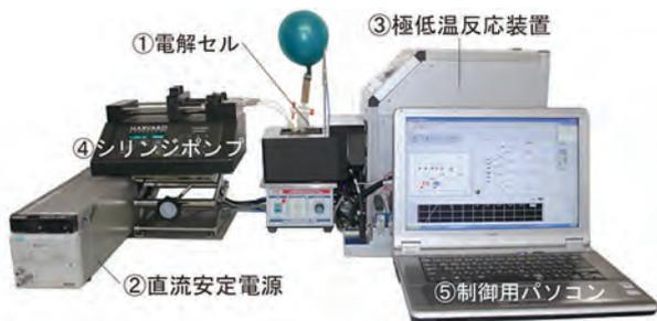
図3 液相電解自動合成装置（1号機）の外観
