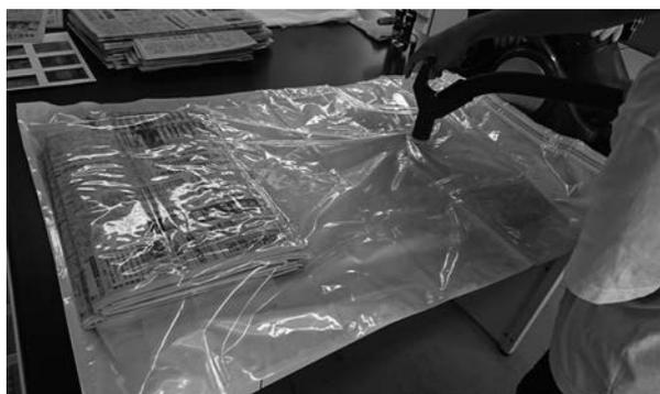
図4 スクウェルチ・ドライイング法の作業様子
