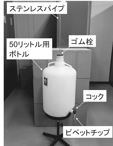
写真1 マリオットボトルを利用した注入器 (MBI)
