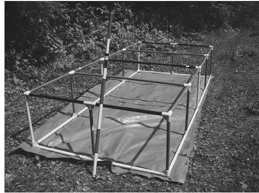
写真 2 落葉・落枝流入防止スクリーンの骨格.
