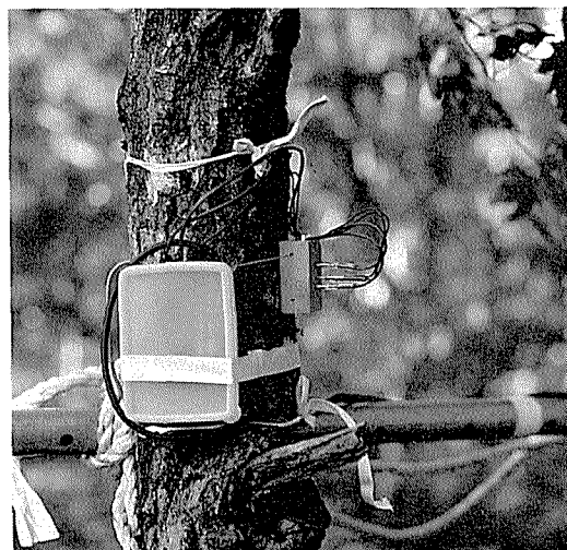
ヒーター，センサー取付け状況 (これらは，熱放散防止のため脱脂綿，アルミ フォイルで保護される)
