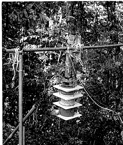
元口吸水のための浸漬槽取付け状況
