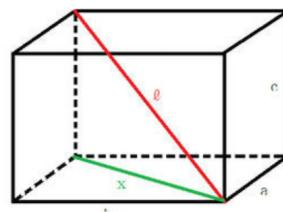
底辺の辺を  $a, b$  として、底面の対角線を  $x$  とおく。三平方の定理より、
