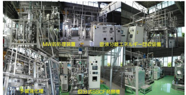
図11. 木質系バイオエタノール製造ベンチプラント
