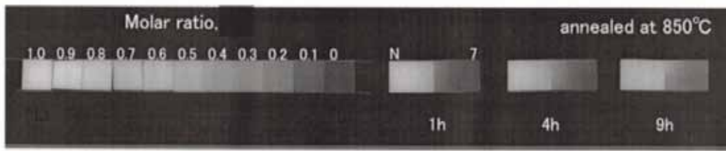
図12 LISICONの標準試料および拡散対試料のNRG像
