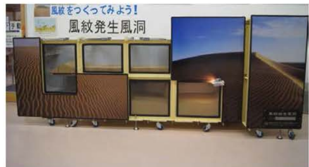
図 22 風紋発生風洞装置
