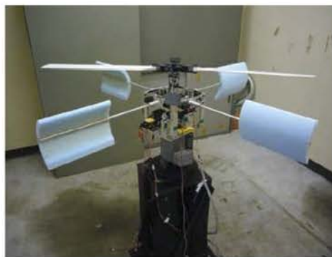
図 21 後置静翼制御機構を用いた UAV
