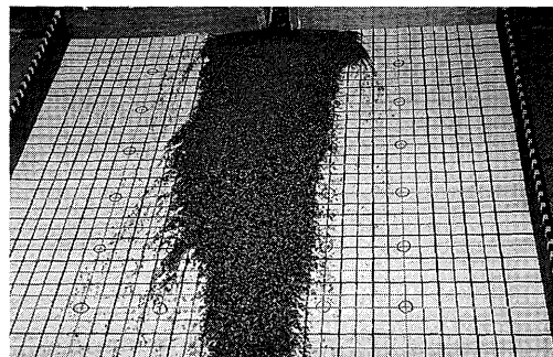
写真2-2 給水停止後の流動体の堆積状況
