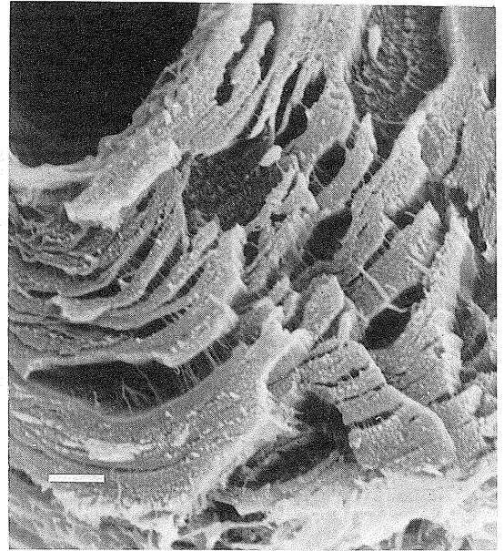
写真24 脱リグニン処理した壁の破断部(ラメラ状破壊) スケールバーは1 \mu\text{m}
