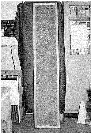
写真5 マウントし完成した土壌断面標本
