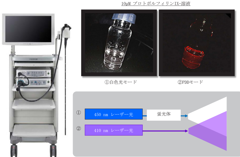
図2 (レーザー) 光線力学的診断用試作内視鏡 (Sie-P1)
