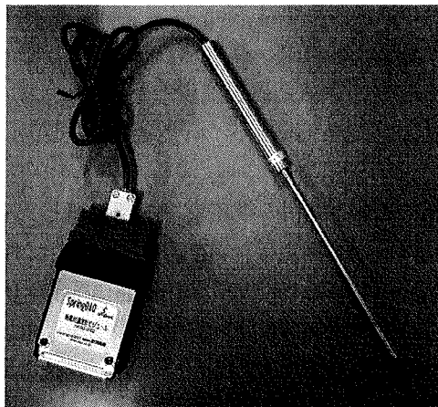
図3 温度センサーを取り付けた測定器
