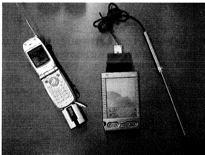
図6 モバイルセンサーの実機による構成
