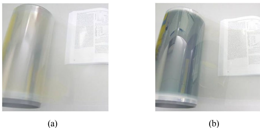
図 5.14 : RTR 法で作製した PET 上 GZO 透明導電膜 : (a)シート抵抗 500 Ω/sq., (b)シート抵抗 13 Ω/sq.
