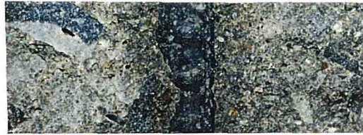
電流密度2.0A/m 2 (積算電流量：6,383A・hr/m 2 )
