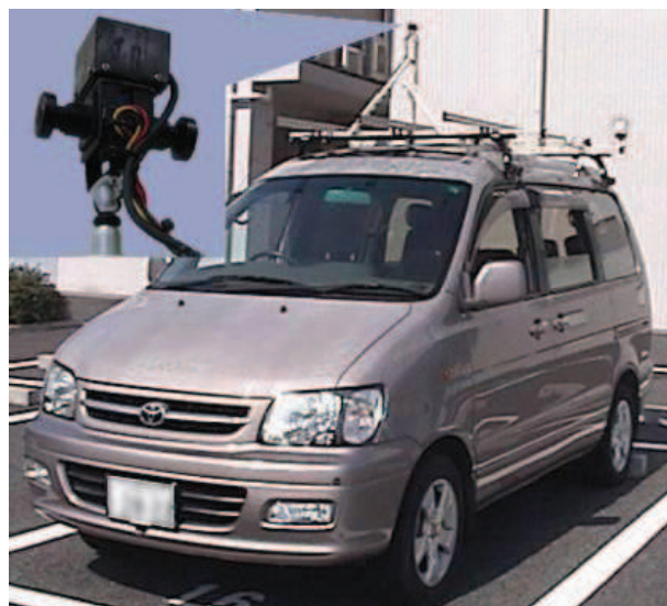
図 3.1 全天周カメラ，慣性センサーとハイブリッド GPS 受信機を車に搭載された様子
