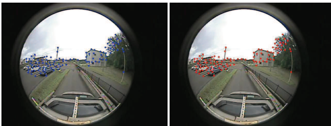
図 3.5 魚眼カメラの隣接している二つのフレームのサンプル画像. 上の点はカメラの運動算出に抽出した特徴点になる
