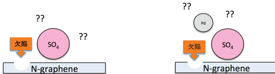
図 6.6: 欠陥あり N 置換グラフェン基板上 SO 4 吸着モデルと SO 4 吸着欠陥あり N 置換グラフェン基板上の Pd 吸着モデルの簡略図
