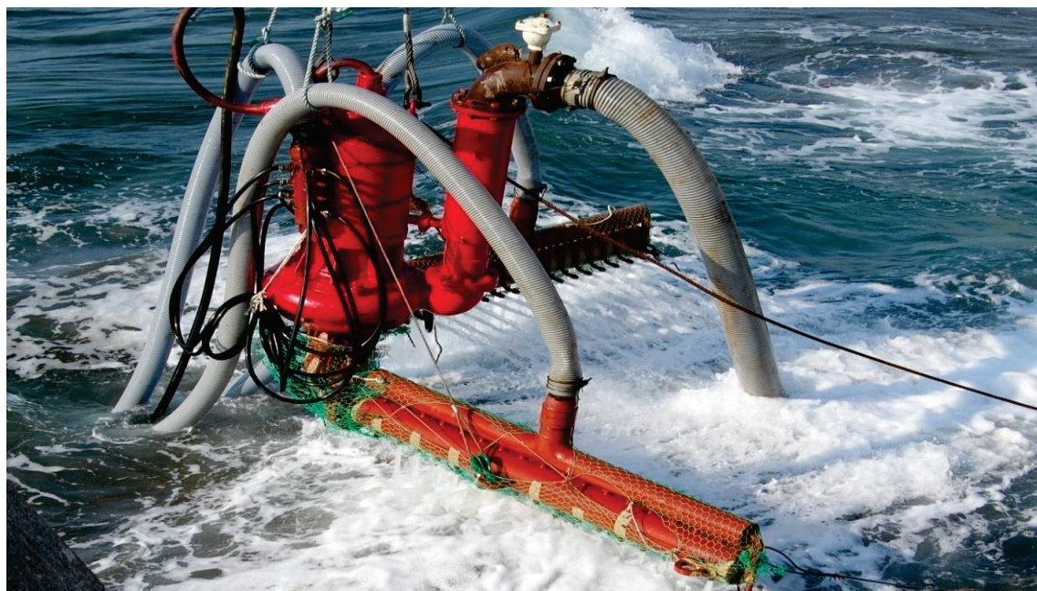
図-3.8 水平 V 字型砂除去装置（野口ら，2007）
