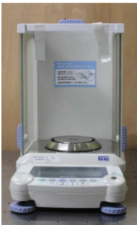
図 3.4 島津製精密天秤の写真 (AUW320)
