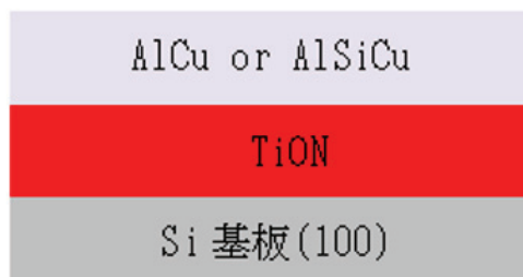
図 3.15 多層積層構造 (2) (断面)
