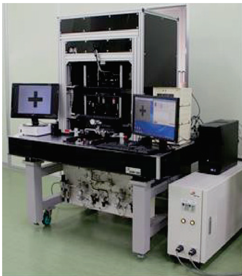
図 4.15 ウェーハの位置合わせと局所的な仮固定が行える装置
