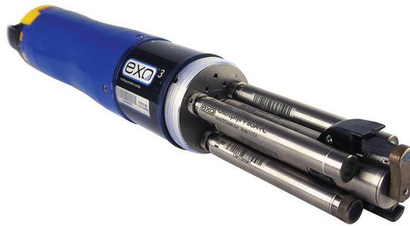
図 2.1 複数センサを組み合わせた水質センサ (YSI Inc./Xylem Inc., EXO3)
