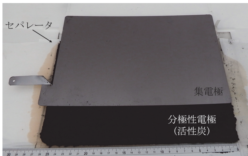
図 2.8 木炭 EDLC の集電極と分極性電極
