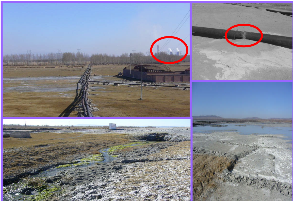
Fig.1-2 火力発電所から野外に排出された石炭灰 Fly ash drained from a thermal power station
