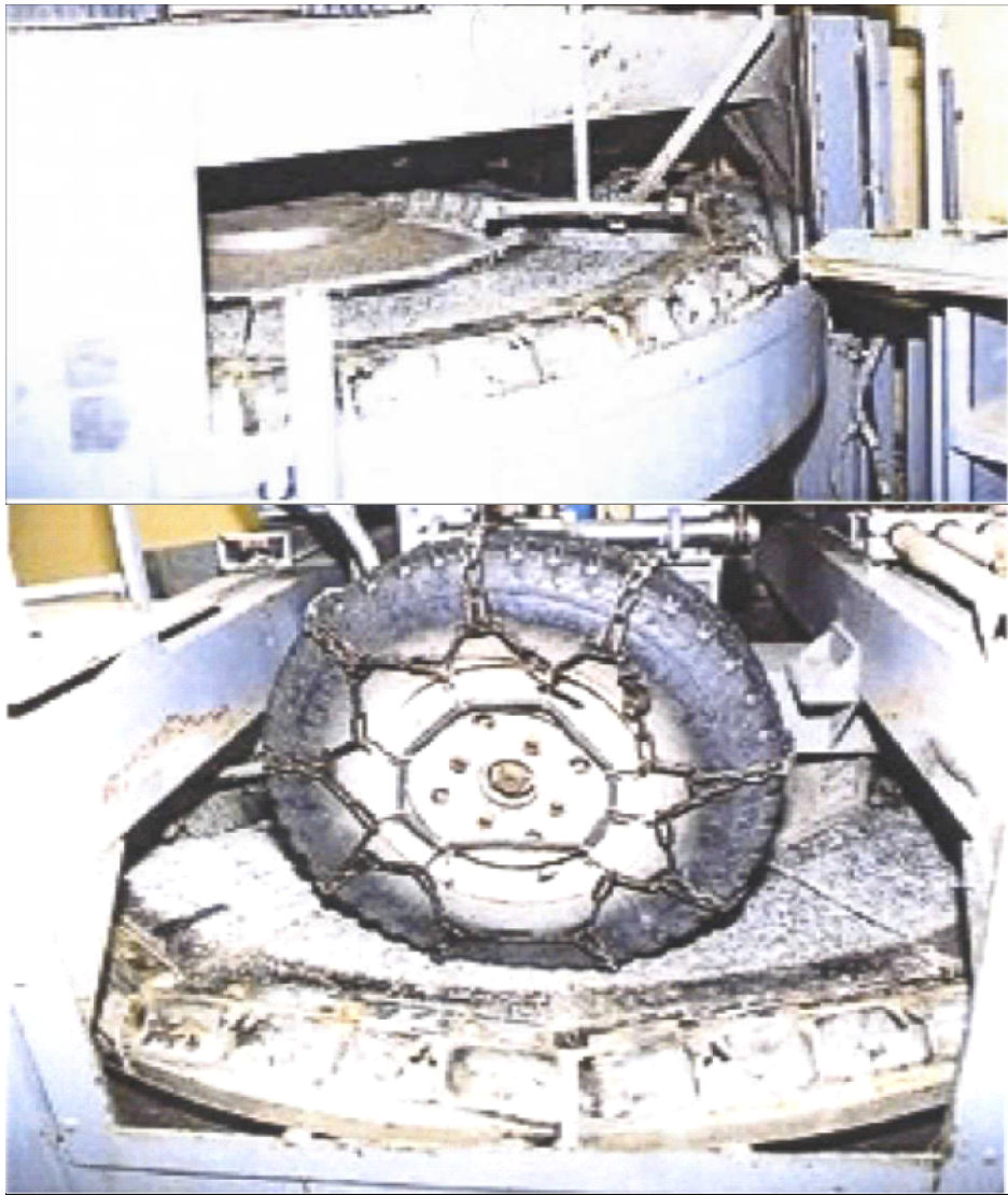
Fig.1-11 ラベリング摩耗試験の様子 19) Labeling abrasion test machine
