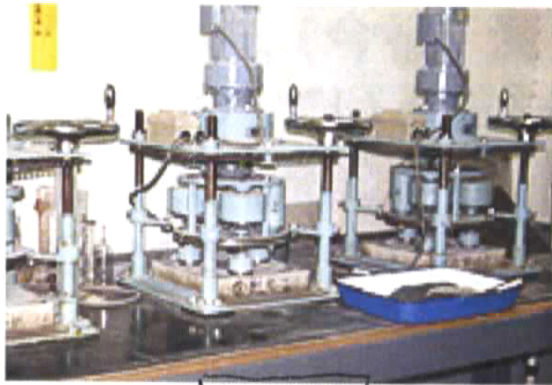
Fig.3-1 摩耗試験 ASTM C 779 による試験の様子 26)
