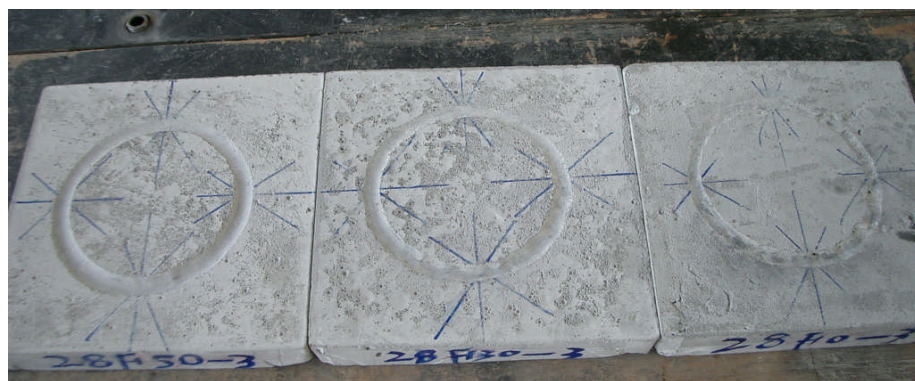
Fig.3-15 摩耗試験後の様子 State after the abrasion test
