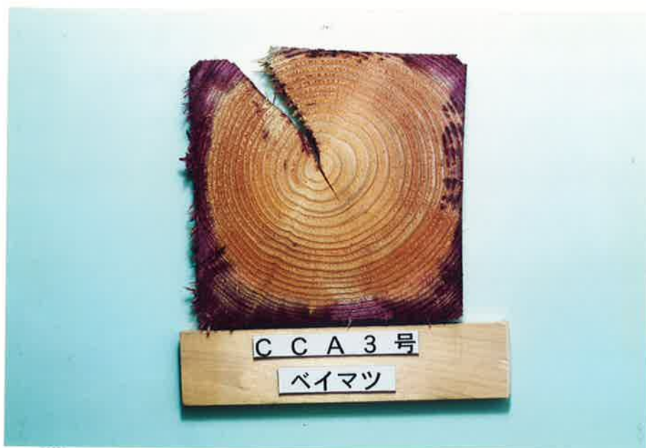
Photo. 4-12 CCA 3号で処理したベイマツ内部での薬剤の浸潤状況
