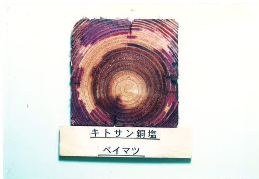
Photo. 4-6 キトサン銅塩で処理したベイマツ内部での薬剤の浸潤状況
