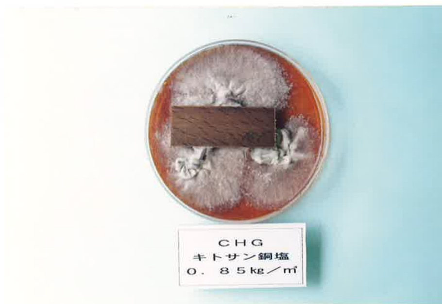
Photo. 7-6 キトサン銅塩の Chaetomium globosum に対する防カビ効力試験状況（銅金属としての平均薬剤吸収量、 0.85\text{kg}/\text{m}^3 ）
