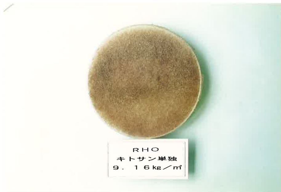
Photo. 7-9 キトサンの Rhizopus oryzae に対する防カビ効力試験状況 (キトサンとしての平均薬剤吸収量、 9.16\text{kg}/\text{m}^3 )
