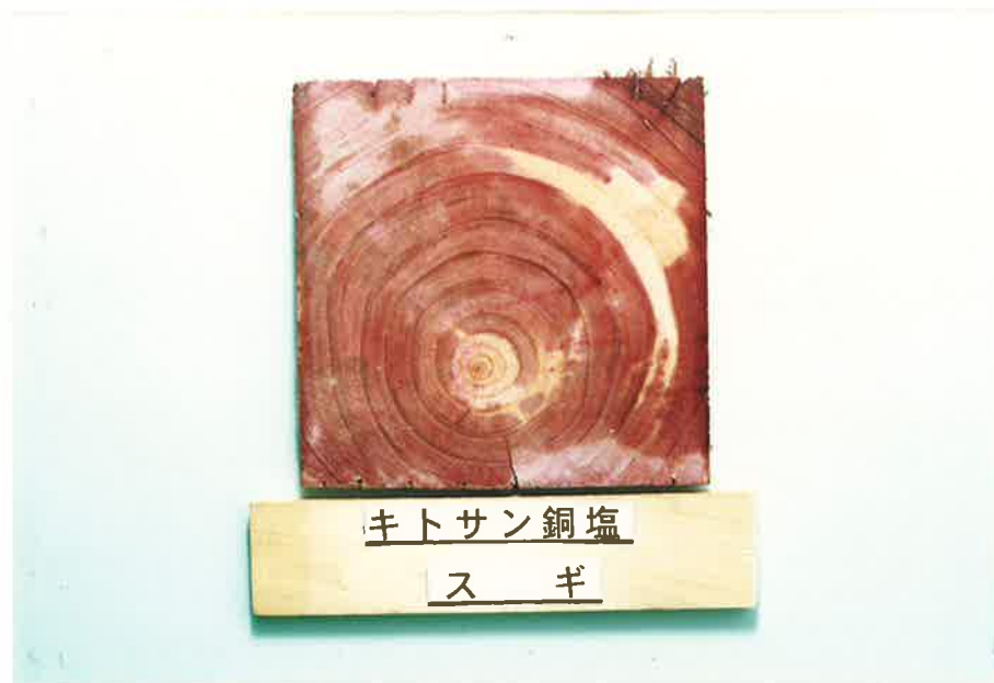
Photo. 4-4 キトサン銅塩で処理したスギ内部での薬剤の浸潤状況
