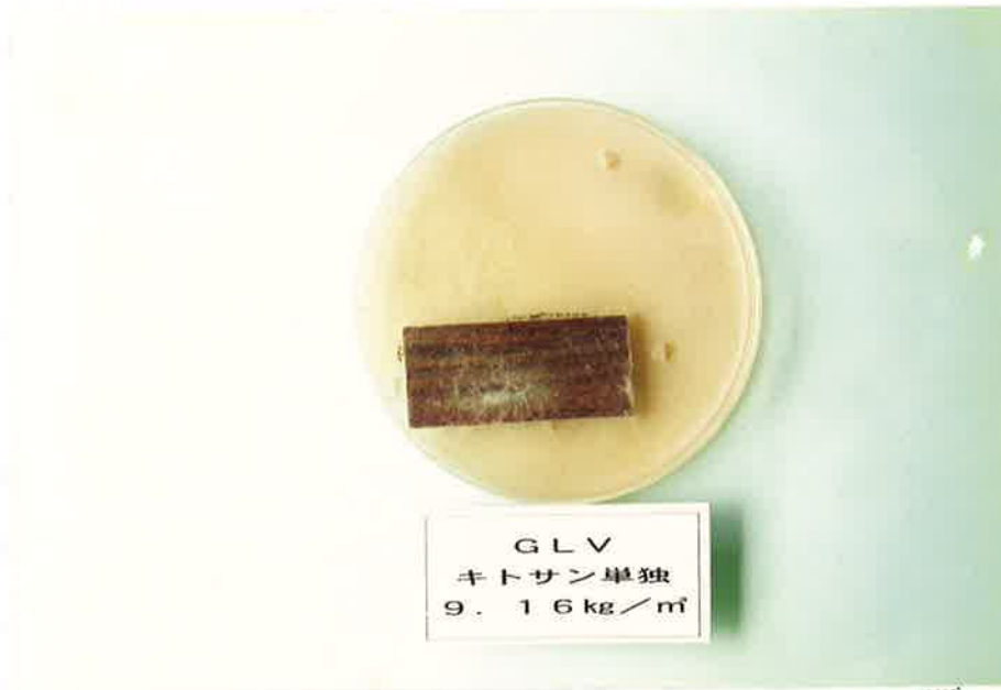
Photo. 7-11 キトサンの Gliocladium virens に対する防カビ効力試験状況 (キトサンとしての平均薬剤吸収量、 9.16\text{kg}/\text{m}^3 )
