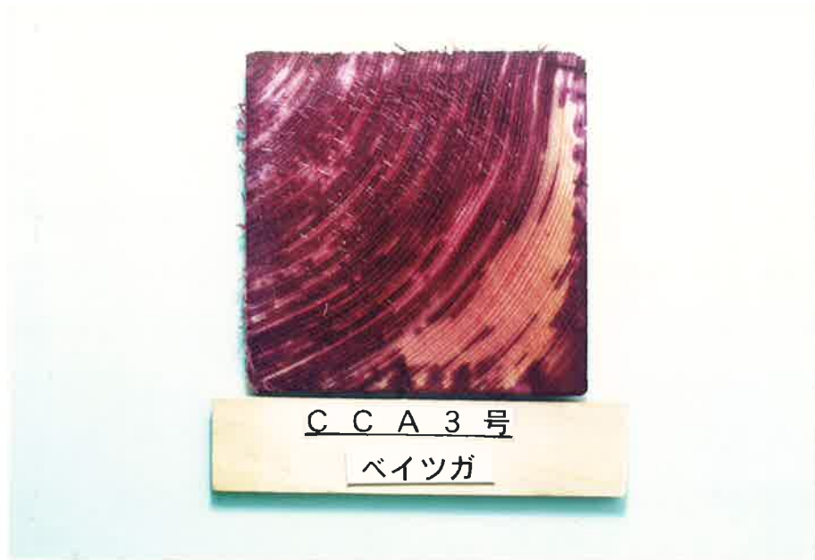
Photo. 4-11 CCA 3号で処理したベイツガ内部での薬剤の浸潤状況
