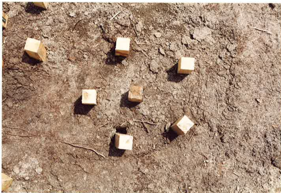
Photo. 6-6 キトサン金属塩の野外試験状況（中央：薬剤処理試験杭、周囲5本：無処理試験杭）
