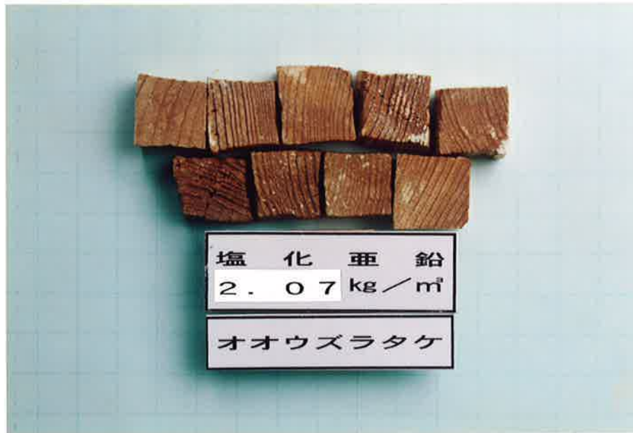
Photo. 5-7 ZnCl 2 処理木材（亜鉛としての平均薬剤吸収量：2.07kg/m 3 ）の防腐効力試験結果（オオウズラタケ）
