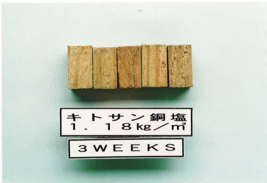
Photo. 6-2 キトサン銅塩処理木材の室内防蟻効力試験結果 (銅金属として 1.18\text{kg}/\text{m}^3 )
