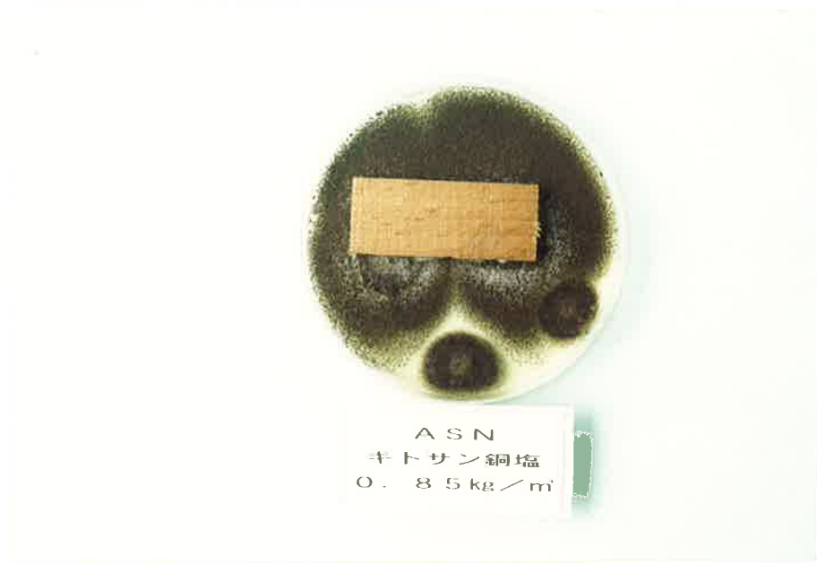
Photo. 7-1 キトサン銅塩の Aspergillus niger に対する防カビ効力試験状況（銅金属としての平均薬剤吸収量、 0.85\text{kg}/\text{m}^3 ）
