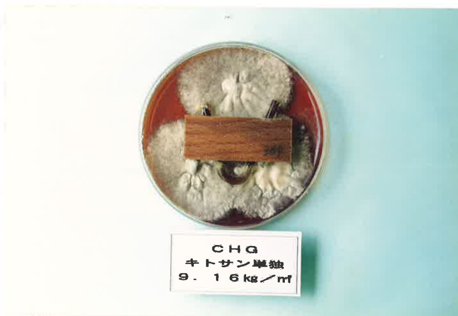
Photo. 7-12 キトサンの Chaetomium globosum に対する防カビ効力試験状況 (キトサンとしての平均薬剤吸収量、 9.16\text{kg}/\text{m}^3 )
