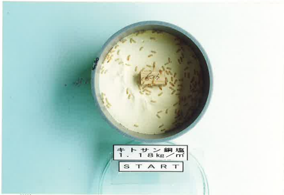
Photo. 6-1 キトサン金属塩の室内防蟻効力試験方法
