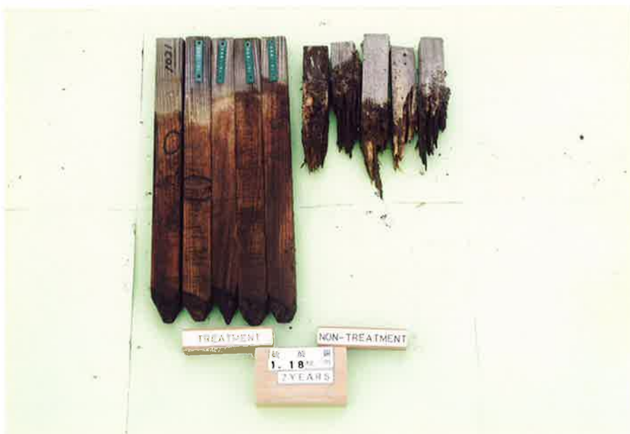
Photo. 6-8 CuSO 4 ·5H 2 O処理木材の野外防蟻効力試験結果（2年目）〔左側：処理試験杭（銅金属として1.18 kg/m 3 ）、右側：無処理試験杭〕
