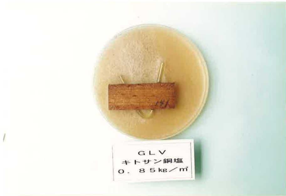
Photo. 7-5 キトサン銅塩の Gliocladium virens に対する防カビ効力試験状況（銅金属としての平均薬剤吸収量、 0.85\text{kg}/\text{m}^3 ）
