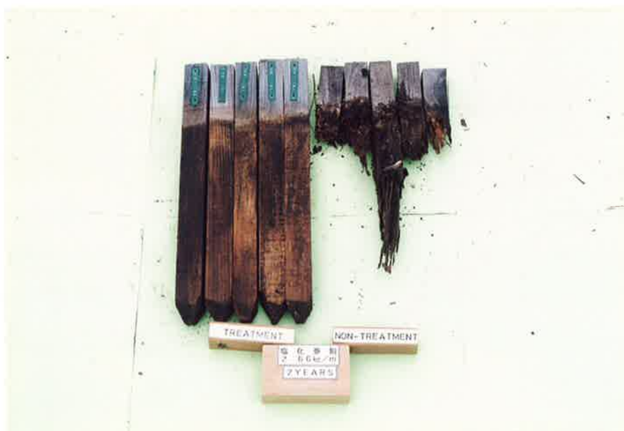
Photo. 6-10 \text{ZnCl}_2 処理木材の野外防蟻効力試験結果（2年目）〔左側：処理試験杭（亜鉛金属として 2.66\text{kg}/\text{m}^3 ）、右側：無処理試験杭〕
