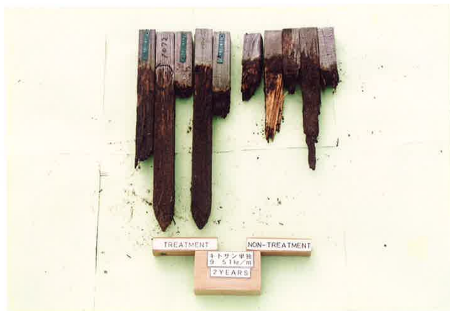
Photo. 6-11 キトサン処理木材の野外防蟻効力試験結果（2年目）〔左側：処理試験体（キトサンとして9.51 kg/m 3 ）、右側：無処理試験体〕
