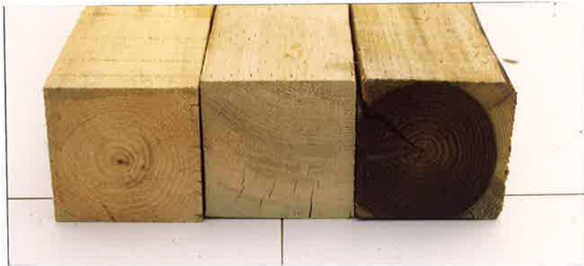
Photo. 4-2 キトサン亜鉛塩により処理した状況 (左;スギ、 中;ベイツガ、 右;ベイマツ)
