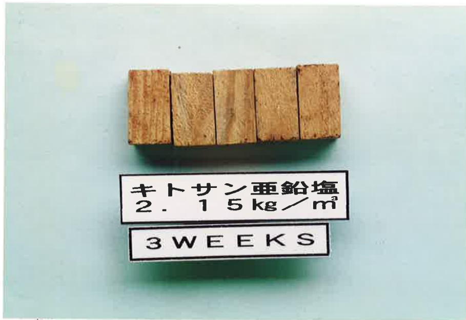
Photo. 6-3 キトサン亜鉛塩処理木材の室内防蟻効力試験 結果 (亜鉛金属として 2.15\text{kg}/\text{m}^3 )
