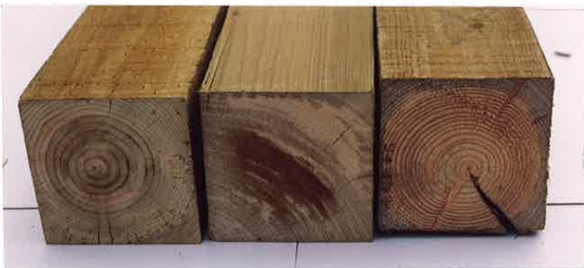
Photo. 4-3 CCA 3号により処理した状況 (左;スギ、 中;ベイツガ、 右;ベイマツ)
