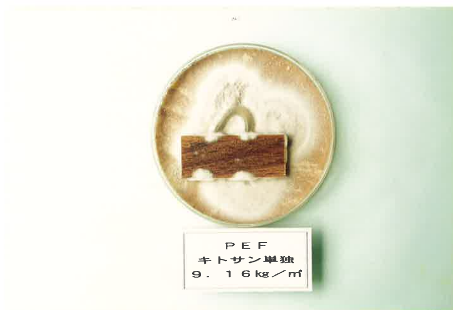
Photo. 7-8 キトサンの Penicillium funiculosum に対する防カビ効力試験状況（キトサンとしての平均薬剤吸量、 9.16\text{kg}/\text{m}^3 ）
