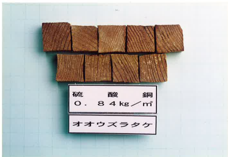
Photo. 5-4 CuSO 4 ·5H 2 O処理材（銅としての平均薬剤 吸収量：0.84kg/m 3 ）の防腐効力試験結果（オオ ウズラタケ）
