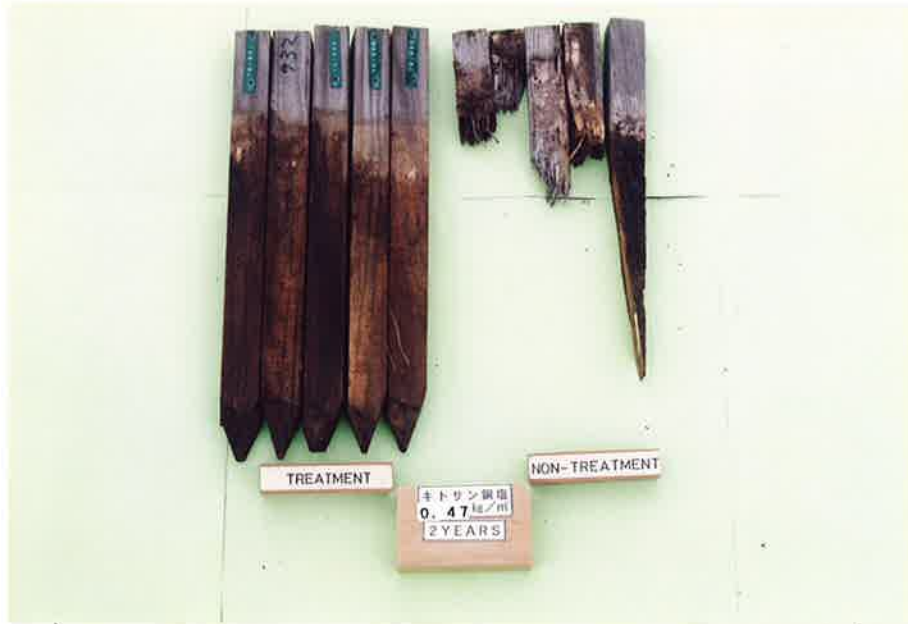
Photo. 6-7 キトサン銅塩処理木材の野外防蟻効力試験結果（2年目）〔左側：処理試験杭（銅金属として0.47kg/m 3 ）、右側：無処理試験杭〕
