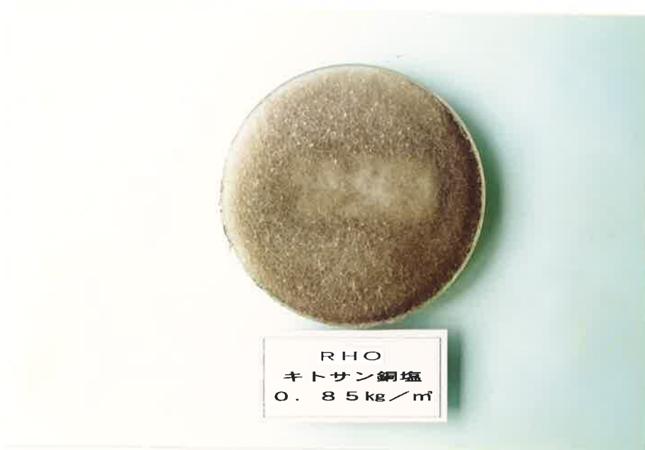
Photo. 7-3 キトサン銅塩の Rhizopus oryzae に対する防カビ効力試験状況（銅金属としての平均薬剤吸収量、 0.85\text{kg}/\text{m}^3 ）
