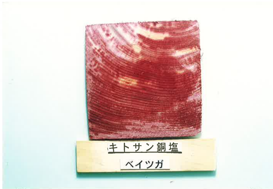
Photo. 4-5 キトサン銅塩で処理したベイツガ内部での薬剤の浸潤状況
