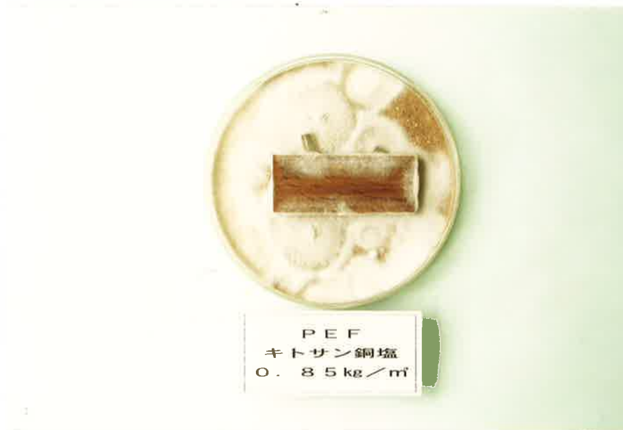
Photo. 7-2 キトサン銅塩の Penicillium funiculosum に対する防カビ効力試験状況（銅金属としての平均薬剤吸収量、 0.85\text{kg}/\text{m}^3 ）
