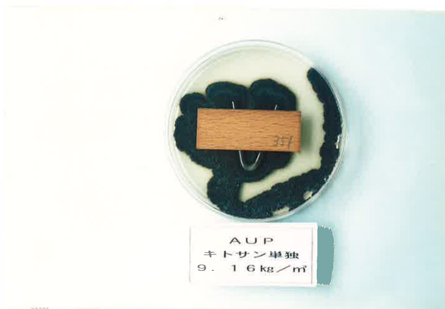
Photo. 7-10 キトサンの Aureobasidium pullulans に対する防カビ効力試験状況 (銅金属としての平均薬剤吸収量、 9.16\text{kg}/\text{m}^3 )
