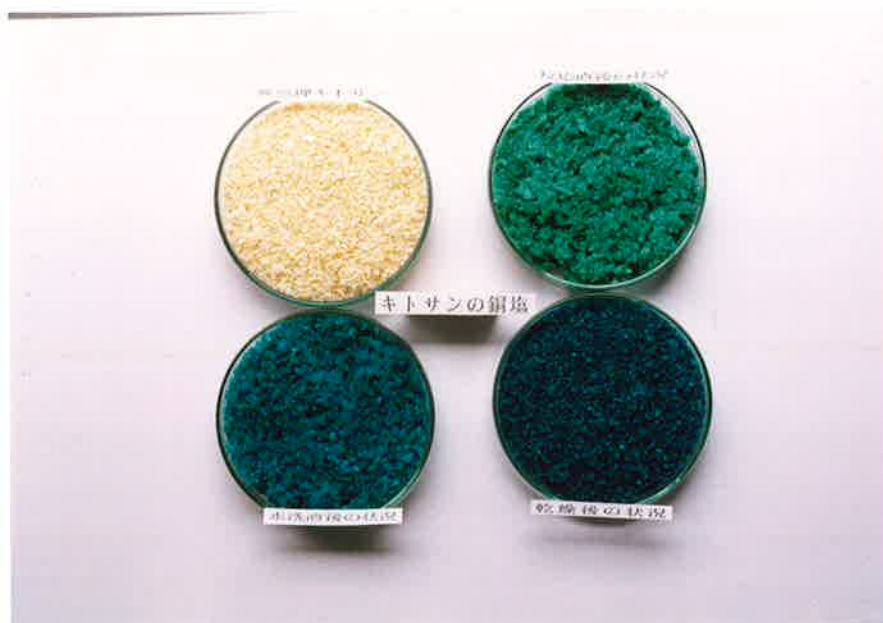
Photo. 1-2 キトサン銅塩の生成直後、水洗後および乾燥後の状況（左上：キトサン、 右上：反応直後、 左下、水洗後、 右下：乾燥後）
