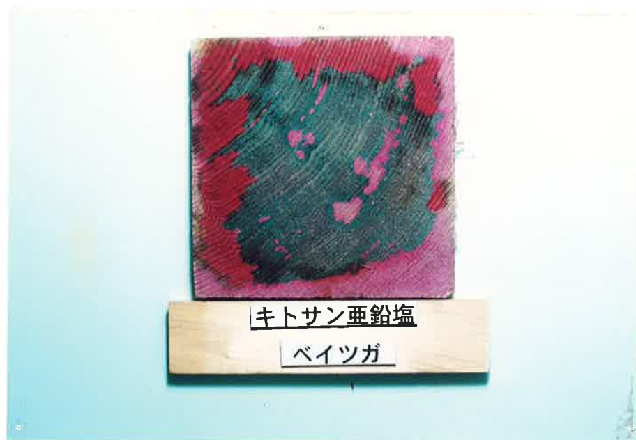
Photo. 4-8 キトサン亜鉛塩で処理したベイツガ内部での薬剤の浸潤状況
