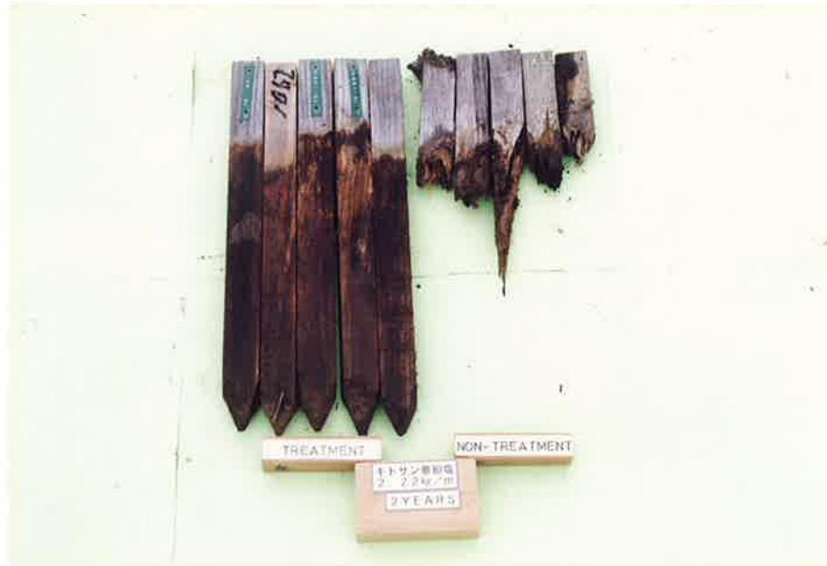
Photo. 6-9 キトサン亜鉛塩処理木材の野外防蟻効力試験結果（2年目）〔左側：処理試験杭（亜鉛金属として 2.22\text{kg}/\text{m}^3 ）、右側：無処理試験杭〕
