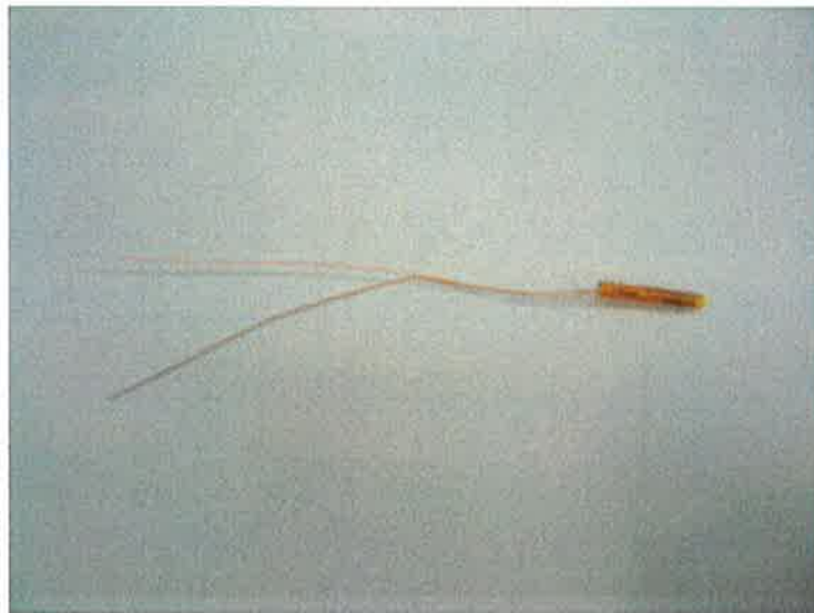
第 3・4 図 埋め込み用のひずみゲージ(共和電業製,KFG・3・120・C20・11)
