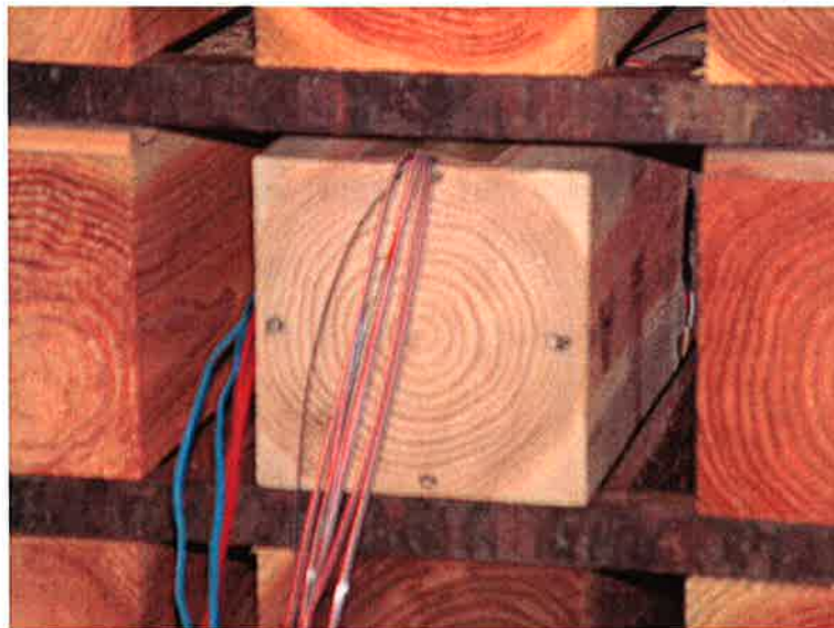
第 3・ 6 図 ひずみゲージを埋め込んだ試験体を他の被乾燥材の中に差し入れリード線をデータロガーに接続して乾燥中のひずみを連続して計測
