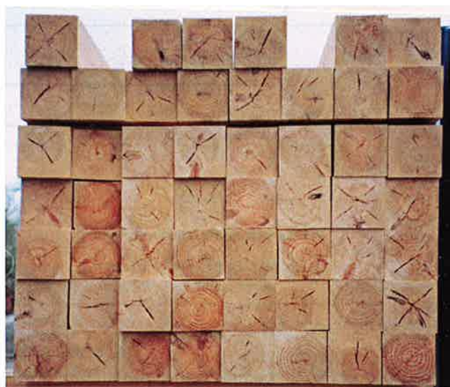
第1-5図 乾燥後、材長300cmの柱材の中央断面を切断した横断面に見られる内部割れ。
