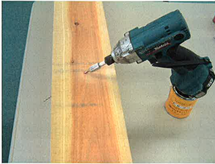
第 3・3 図 側面中央より斜め 45 度にドリルで 2.5mm の埋め込み孔を隣接の側面中央に向けて貫通させた
