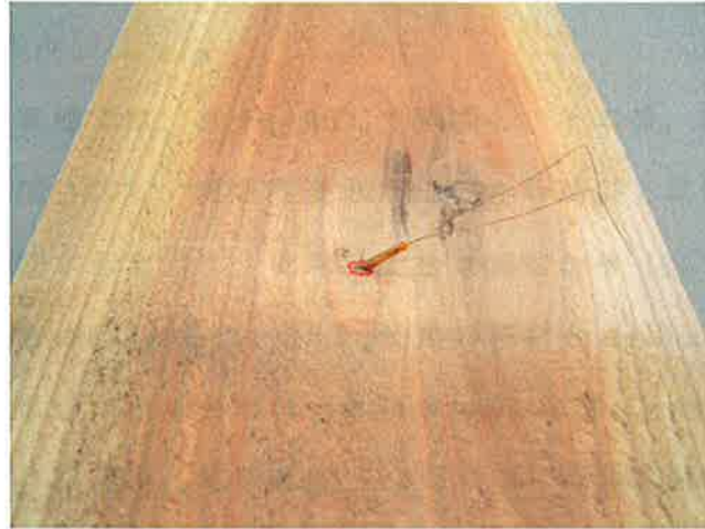
第 3・ 5 図 ゲージが孔の中央にくるようにセットしリード線を出しておきながら，孔の入口からゲージ固定用エポキシ樹脂接着剤(共和電業製,EP-34B)を計測孔全体に注入して充填密封した。
