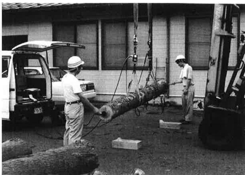
第 1 - 2 - 2 図 丸太材の固有振動周波数測定の様子
