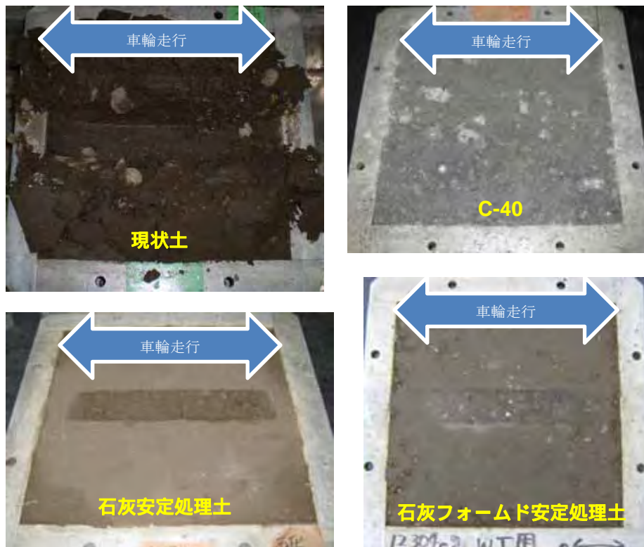
写真-5.3 ホイールトラッキング試験後の供試体表面の状態
