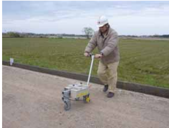
写真-6.4 横断形状の測定状況
