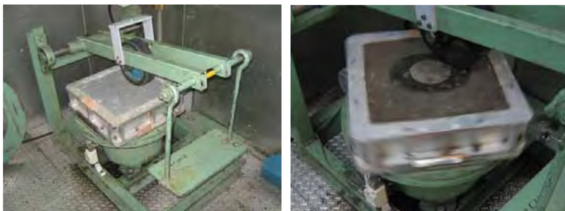
写真-5.4 回転ホイールトラッキング試験状況
