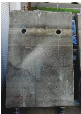
写真 2-7 垂直方向のひび割れ評価用ブロックの表面状態
