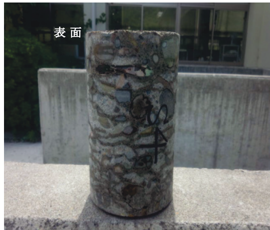
写真 6-4 コア供試体 No.3 の側面の状態
