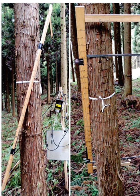
写真2-5 立木に固定した治具と センサー挿入箇所のマーク
