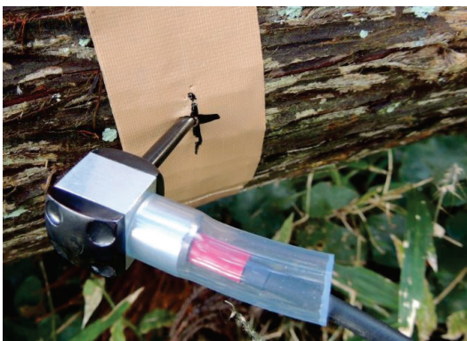
写真4-4 センサー挿入箇所のマーク
