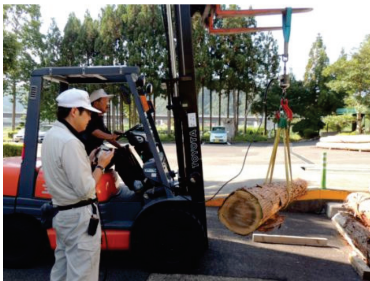
写真3-5 フォークリフトを用いた丸太の重量計測の状況
