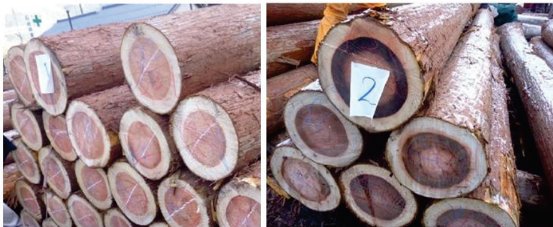
写真4-2 鳥取県東部の木材市場でのスギ赤心材(左)とスギ黒心材(右) このときの m^3 単価は赤心 19,000 円/ m^3 、黒心 13,000 円/ m^3 (2015.12 智頭)
