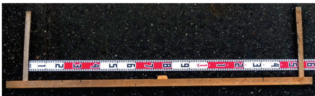
写真 2-3 実際の斜め測線設定用治具
