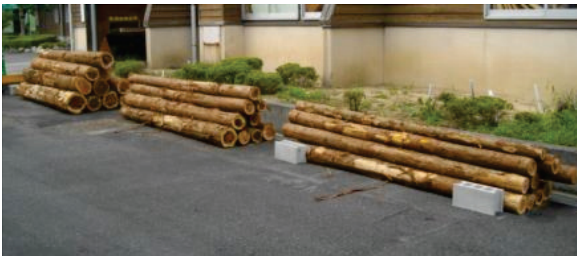
写真 3-4 試験場構内に設置したはい積み 左から径級大、中、小
