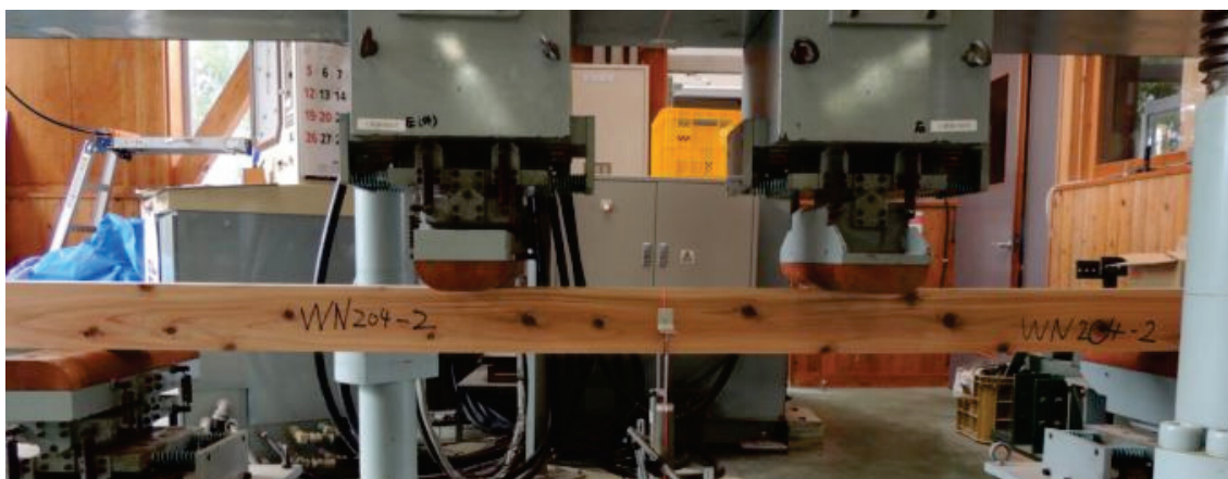
写真2-6 立木で強度性能推定した個体の製材品の曲げ試験状況
