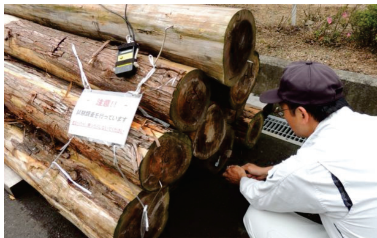
写真3-6 FAKOPP を用いた丸太の SPT 計測の状況
