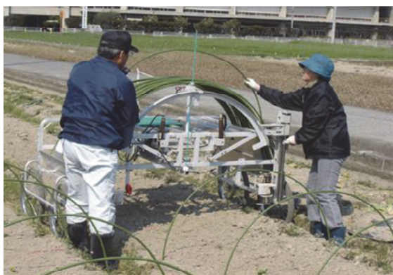
図 3-2-4 試作機による支柱設置作業状況
