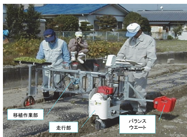
図2-1-5 試作1号機の外観と移植作業状況
