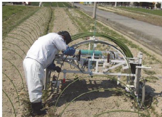
図 3-2-4 試作機による支柱設置作業状況
