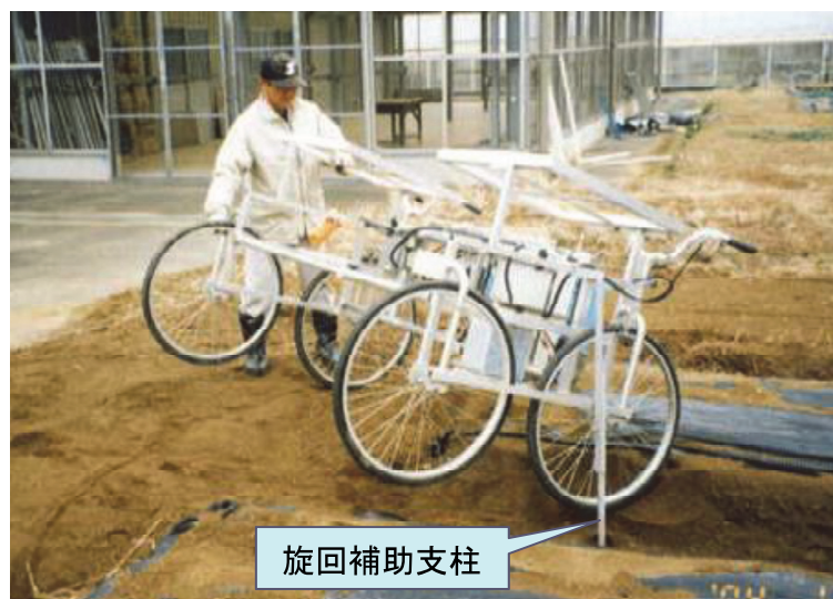
図 2-1-8 旋回用補助支柱を装備した試作 2 号機の旋回の様子
