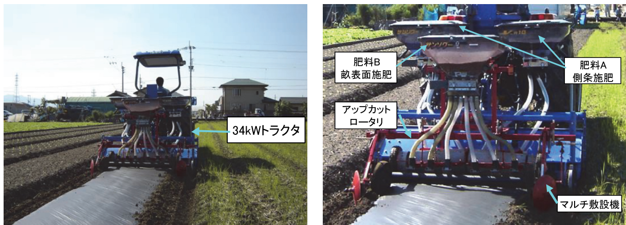
図 4-2-1 アップカット耕うん畝立て施肥マルチ敷設機の外観と作業状況
