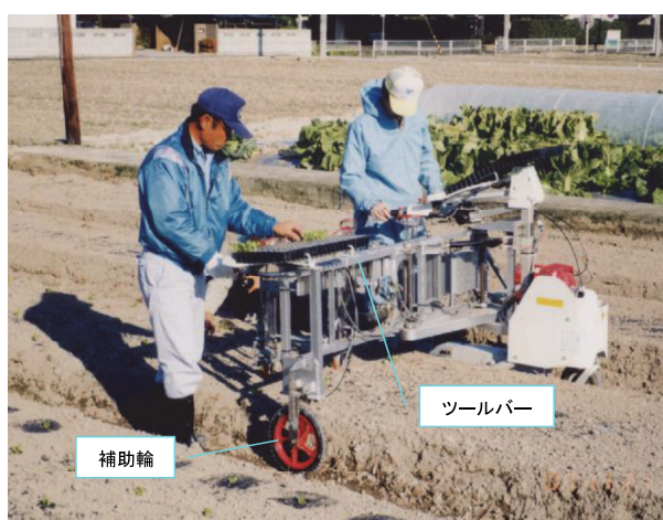
図2-1-5 試作1号機の外観と移植作業状況
