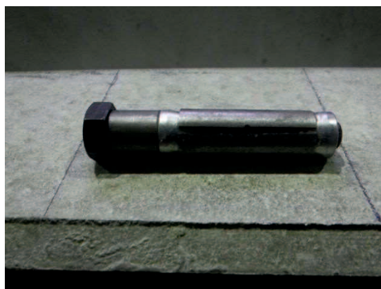
写真 4.6 ひび割れ誘発アンカー
