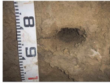
変形が見られるが、空洞部が維持され ている箇所 (2015年7月30日)
