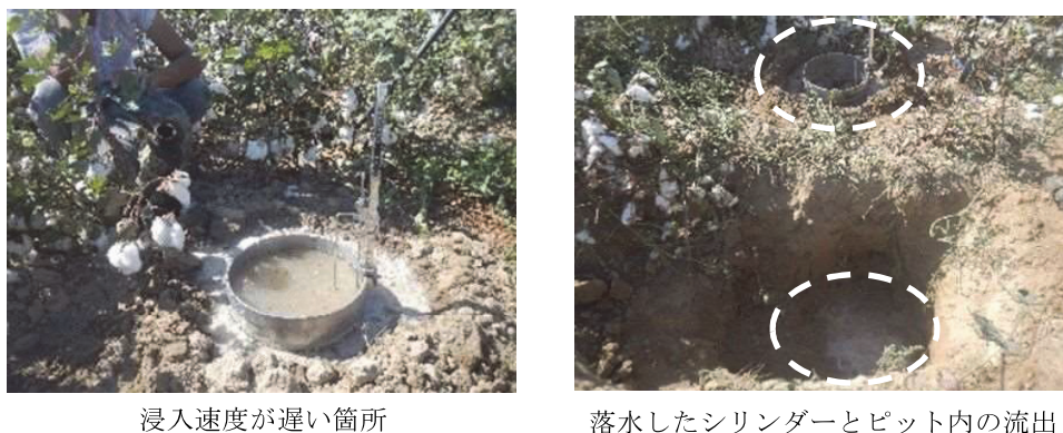
Fig. 6-7 シリンダーインテークレート試験状況
