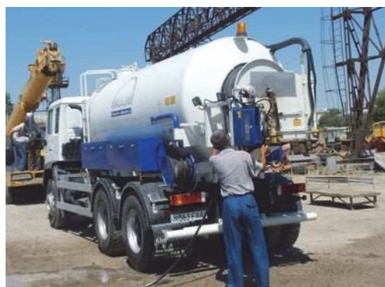
シルダリア州 HGME が所有する暗渠排水用高圧洗浄機 (2014/6/18)
