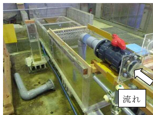
Fig.2-6 流量制御バルブ
