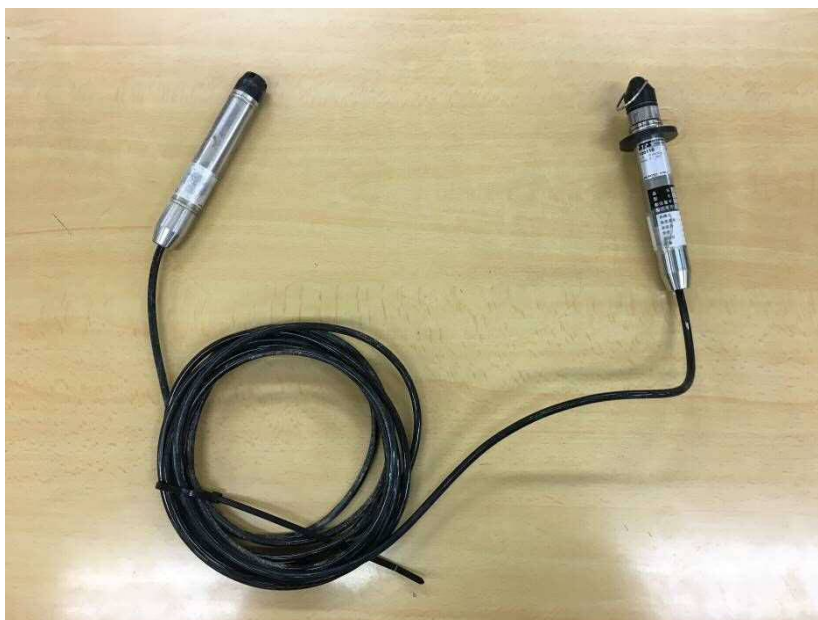
Fig.4-5 データロガー付水位計
