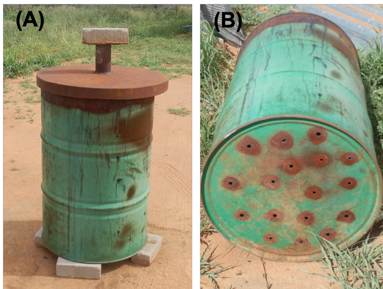
Fig. 4-1. ジャトロファ落葉バイオチャーを製造した、中古ドラム缶を利用した簡易炭化装置。(A)側面。ドラム缶はレンガの上に乗せ、自作した煙突付きの蓋で上部を塞いだ。熱分解を進める際には煙突の上部をレンガで塞いだ。(B)底面。熱分解開始時に空気を取り入れる穴を複数開けた。
