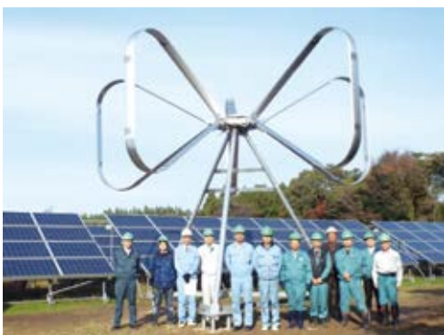
直径7mのバタフライ風車試作機の完成記念写真 学生2名が組立作業に参加（撮影：2016.11.18）
