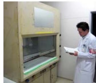
職場巡視（ドラフト検査）
