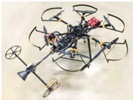
橋脚点検・診断用マルチコプタの試作機
