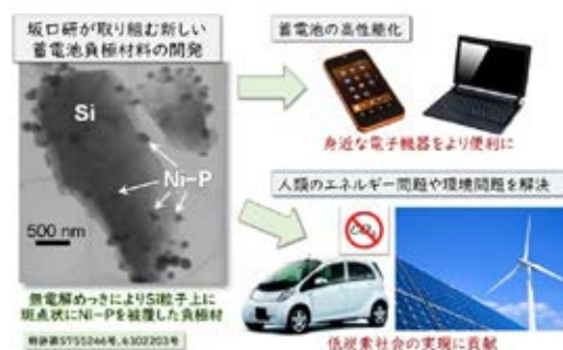
坂口研究室が取り組む蓄電池負極材料の開発とその応用例
