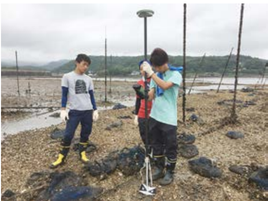
GPSを用いた干潟地形測量
