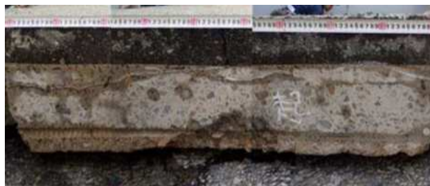
写真-1 RC 床版の内部水平ひび割れの事例
